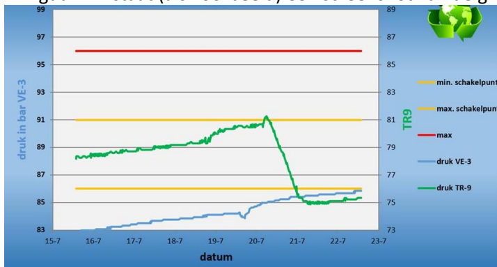
Figuur 1.4 Snapshot drukverloop VE-3 en TR-9 (jul 24) als verloop van tijd, met als rode lijn de alarm druk aan het wellhead, afgeleid van de maximum casingschoendruk. De gele lijnen zijn gewenste operating-drukken bij normaal bedrijf. Soms wordt bij hoge pekelsvraag VE-3 extra afgelaten, met drukken onder het minimum schakelpunt als gevolg.
