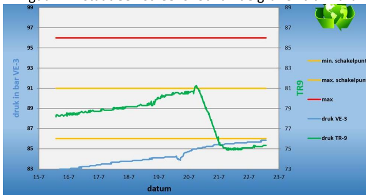
Figuur 1.4 Snapshot drukverloop VE-3 en TR-9 (jul 24) als verloop van tijd, met als rode lijn de alarm druk aan het wellhead, afgeleid van de maximum casingschoendruk. De gele lijnen zijn gewenste operating-drukken bij normaal bedrijf. Soms wordt bij hoge pekelsvraag VE-3 extra afgelaten, met drukken onder het minimum schakelpunt als gevolg.
