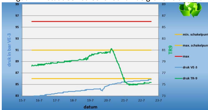
Figuur 1.4 drukverloop VE-3 en TR-9 (jul 24) als verloop van tijd, met als rode lijn de alarm druk aan het wellhead, afgeleid van de maximum casingschoendruk. De gele lijnen zijn gewenste operating-drukken bij normaal bedrijf. Soms wordt bij hoge pekelsvraag VE-3 extra afgelaten, met drukken onder het minimum schakelpunt als gevolg.
