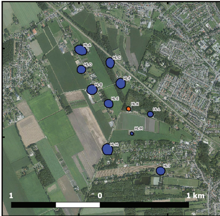
B3-3. Zoutcavernes ten noordoosten van Veendam, bij Heiligerlee. De in blauw aangeduide cavernes zijn in beheer bij Akzo (voor zoutwinning), de oranje (HL-K) wordt gebruikt voor de opslag van stikstof door een dochterbedrijf van Gasunie. De cavernes zijn tot 4.000.000 m 3 , en zijn tot 800 m hoog. Ze zitten op dieptes tussen de 800 en 1600 m.
