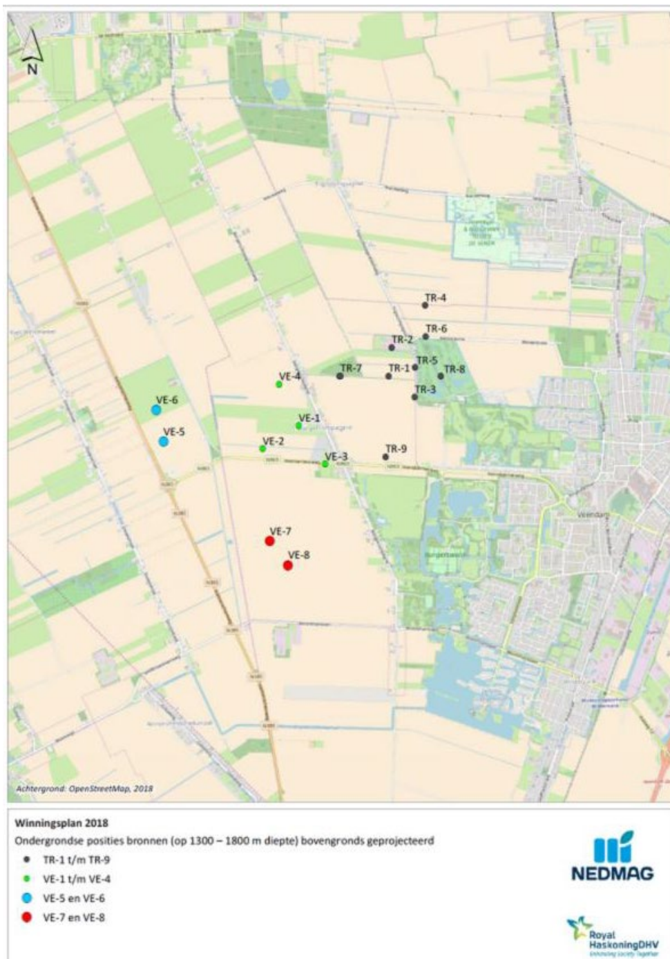
Figuur 9: Ondergrondse positie huidige en nieuwe bronnen (met een mogelijke afwijking van 200m voor de nog te boren bronnen VE-5 tot en met VE-8).
