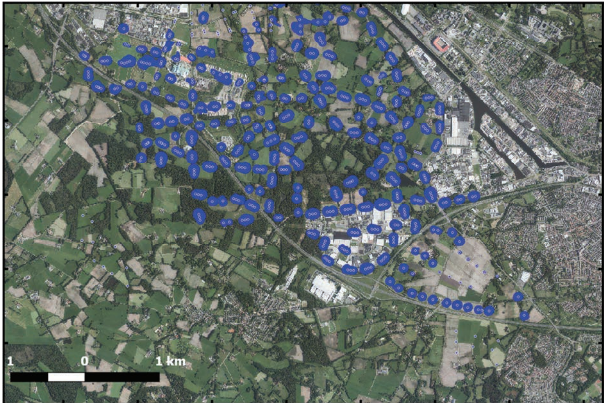
B3-5. Zoutcavernes van Akzo in het gebied ten zuiden van Hengelo – Enschede in Twente. De cavernes zijn aangeduid met blauwe vlekken, de kleine rondjes geven aan waar de boringen zich bevinden. Deze cavernes bevinden zich rond de 400 m diepte, en zijn veelal vrij klein (met een hoogte van enkele tientallen meters).
